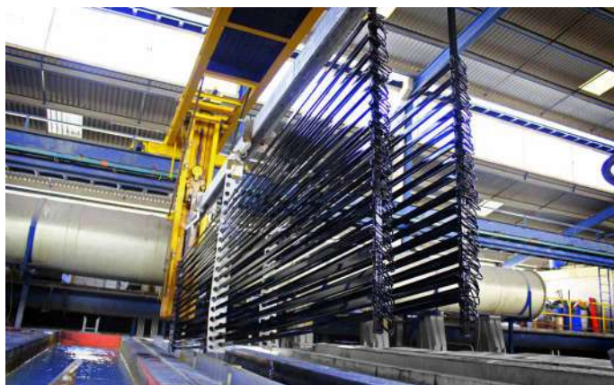
Planta de anodizado totalmente automatizada para garantizar confianza en la calidad de nuestros productos.
