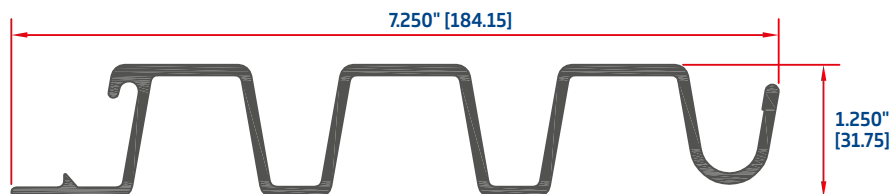
PERFIL P/PISO REFRIGERADOR 9808
